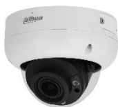
• Dôme extérieur • Série WizSense • 8MP (3840x2160) • IP • Progressive scan CMOS Starlight • IVS: Traversée de ligne - Détection de zone - Distinction entre véhicules et personnes • Objectif motorisé 2.7-13.5mm f/1.5 • 113°-31° • WDR 120dB • Infra-rouge jusqu'à 40m • H265 - H264 - H264B - H264H - MJPEG (2ième stream) • 20 Images/sec. - 25 Images/sec. hors fonctions AI • IP67 - IK10 • PoE: IEEE 802.3af PoE • Consommation: 8.2W max. • 12VCC • Temp: -30° C à +60° C • Audio: non disponible • Alarme: non disponible • MicroSD - max. 256Gb • Onvif profile G/S/T • Couleur: blanc • Diam: 122x88.9mm • Accessoires optionnels: PFA137 - PFA200W - PFB203W - PFA152-E - PFA106 - PFB220C - PFB200C
