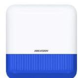
• Sirène extérieure sans fil • Fréquence de 868MHz • Portée RF 1600m • 3 types d'alarme sonores: alarme incendie, alarme panique et alarme intrusion • Buzzer de 90 à 110dB • Cryptage AES-128 • Protection contre le sabotage à l'avant et à l'arrière • Flash LED bleue • IP65 • Possibilité de raccordement à une alimentation de 230V
