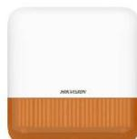
• Sirène extérieure sans fil • Fréquence de 868MHz • Portée RF 1600m • 3 types d'alarme sonores: alarme incendie, alarme panique et alarme intrusion • Buzzer de 90 à 110dB • Cryptage AES-128 • Protection contre le sabotage à l'avant et à l'arrière • Flash LED orange • IP65 • Possibilité de raccordement à une alimentation de 230V
