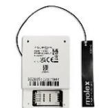
Module GSM 4G pour transmission vocale, transmission vers dispatching, programmation à distance via canal GSM et commande via Risco Cloud. • Antenne GSM incluse et à utiliser avec le boîtier plastique LIGHTSYS+\_PLASTIC-BOX/S et LIGHTSYS+\_PLASTIC-BOX/L. • A utiliser avec la centrale LightSYS+ • Consommation de courant 12Vdc : 30mA (typique) / 300mA (max) ! Nécessite une carte SIM VOLTE en cas de communication vocale.
