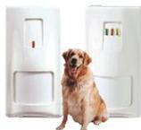
Détecteur IRP+RADAR DigiSense. • Immunité aux animaux domestiques jusque 45 kg • Hauteur de montage: 2.10m (lentille RL111H) / 2.40m (lentille RL108PTH) • Portée: 11m x 11m (lentille RL111H) / 8m x 8m (lentille RL108PTH) • Technologie de détection IRP: Lentille • Résistances d'alarme et sabotage intégrées et sélectionnables (choix: aucune/1K0/2K2/4K7/5K6/6K8)
