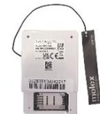
Module GSM 4G pour transmission vocale, transmission vers dispatching, programmation à distance via canal GSM et commande via Risco Cloud. • A enficher sur la centrale LightSYS AIR. • Consommation de courant 12Vdc : 30mA (typique) / 300mA (max) ! Nécessite une carte SIM VOLTE en cas de communication vocale.
