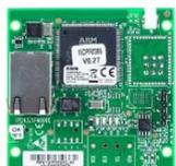
Module de communication IP avec fonctionnalité multi canaux. ! A utiliser avec les centrales ProSYS Plus, LightSYS (à partir de version 5.20) et Agility (à partir de version V5.10).
