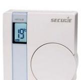
Module chauffage Z-Wave • Thermostat mural sans sortie relais libre de potentiel • Nécessite un module relais externe SSR303 pour la commande de la chaudière/pompe à chaleur • Température souhaitée réglable via commutateur rotatif (5-30°C) • Affichage LCD avec rétro-éclairage • Alimentation: 2 piles AAA (incluses) • Dimensions (LxHxP): 86x86x36 mm
