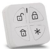
Émetteur bidirectionnel 4 boutons sans fil 868MHz, finition blanche. • LED tricolore pour confirmation visuelle de la commande • Pile incluse: 1 fois Lithium 3V, type CR2430 • Dimensions (H x L x P): 41 x 41 x 17 mm ! A utiliser en combinaison avec le système Agility (à partir de version 5.10), WiComm Pro (à partir de version 5.10), LightSYS (à partir de version 5.80), LightSYS+, LightSYS AIR, ProSYS Plus (à partir de version 1.2.1.17) et module répéteur AGILITY-REPEATER/2W.
