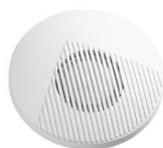
Sirène intérieure • Finition blanche • Commande par apparition du 12Vdc • Choix entre 3 tonalités de sirène • Rendement sonore de 120 dBA à 1 mètre • Consommation de 320mA • Dimensions (L x H x P): 130 x 130 x 40 mm
