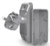
Kit de montage mural pour les détecteurs extérieurs SA-OPAL, SA-OPAL-PLUS, SA-OPAL-PRO et SA-AOD-200/210. Se compose de 2 supports pour montage mural : 1. Support mural pivotant • Réglable horizontalement sur 90° (maximum 45° à gauche et 45° à droite) • Réglable verticalement sur 60° (maximum 30° vers le haut et 30° vers le bas) • Plastique gris foncé 2. Support mural fixe • Pour montage fixe sous un angle de 45° • Plastique gris foncé
