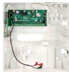
Centrale PERFECTA 32-WRL en petit boîtier en plastique, version néerlandaise. • Equipée de base de 8 zones, extensible à 32 zones • Equipée d'un transceiver sans fil, 433MHz • Maximum 2+1 partitions • 15 codes utilisateur • Equipée d'origine d'un module de communication GSM/GPRS • Antenne SA-ANT-GSM-I incluse • Boîtier plastique SA-OPU-4P inclus ATTENTION: Nécessite un transfo SA-TR-40VA, non inclus!
