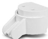
Support plafond et mur pour détecteurs SA-AQUA PLUS, SA-AQUA PRO, SA-GRAPHITE, SA-SILVER, SA-AGATE, SA-APD-100, SA-APMD-150, SA-MPD-300, SA-AOCD-250 et SA-AOCD-260. Pas de passage de câble intégré. Adaptation de 30° de l'angle d'inclinaison. Adaptation de 90° de l'angle de rotation.
