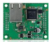
Extension Ethernet pour le module de communication universel GSM/GPRS/2G/SMS SA-GSM-X. • Module enfichable rendant la transmission Ethernet câblée possible en tant que support primaire, support back-up ou solution DUAL de transmission de rapports
