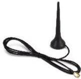
Antenne 900/1800 MHz avec socle magnétique et câble de 2,5m. Convient pour la connexion à un connecteur type SMA.
