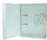
Grand boîtier vide avec transfo 50VA et interrupteurs sabotage pour centrales INTEGRA64/128 ainsi que pour les extensions SATEL. Place pour loger deux batteries 12V/18Ah. Dimensions (LxHxP): 420 x 525 x 130 mm.
