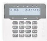
Clavier LCD sans fil ABAX2 pour centrales VERSA, VERSA PLUS et VERSA PLUS IP. • Rétro-éclairage blanc • Lecteur de proximité intégré (125kHz) • Dimensions (lxhxp): 139x124x22 mm • 2 piles CR123A incluses ATTENTION: Nécessite un récepteur SA-ACU-220/120 ou SA-ACU-280/270!
