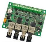
Module pour convertir le bus clavier et bus d'extension de la centrale INTEGRA et INTEGRA PLUS vers une liaison fibre optique. Distance de max. 2km.
