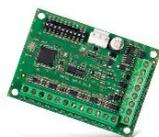
Extension 8 zones pour centrales PERFECTA, VERSA, VERSA PLUS, VERSA PLUS IP, INTEGRA et INTEGRA PLUS (hors boîtier). Raccordement possible d'une alimentation supplémentaire contrôlée SA-APS-412 via connexion rapide.
