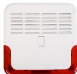
Sirène extérieure avec lampe flash rouge. • Finition blanche en polycarbonate • Flash rouge intégré par LED • Activation séparée d'une LED pour indication visuelle au choix • Fonctionnement jusque fin de commande ou protection via minuterie jusque 1, 5, 10 ou 15 minutes • 4 tonalités réglables • Volume sonore 120 dBA à 1 mètre • Température de fonctionnement: -25 à 70°C • Dimensions (L x H x P): 230 x 230 x 65 mm
