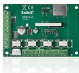
Module ABAX2 qui permet de transmettre 4 contacts sans fil et/ou piloter 4 sorties relais sans fil SA-ACU-220/120/280/270. • Dimensions (lxhxp): 126x158x32 mm ! A utiliser en combinaison avec le système BE WAVE SA-SMART HUB et SA-SMART HUB PLUS, l'émetteur-récepteur SA-ACU-220 ou SA-ACU-280.
