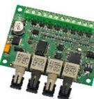
Module pour convertir le bus clavier et bus d'extension de la centrale INTEGRA et INTEGRA PLUS vers une liaison fibre optique. Distance de max. 2km.
