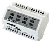
Extension 8 relais pour centrales PERFECTA, VERSA, VERSA PLUS, VERSA PLUS IP, INTEGRA et INTEGRA PLUS. Relais prévus pour la commutation de 230VAC/16A. Montage sur rail DIN.
