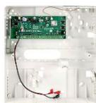
Centrale PERFECTA 32 en petit boîtier en plastique, version française. • Equipée de base de 8 zones, extensible à 32 zones • Maximum 2+1 partitions • 15 codes utilisateur • Equipée d'origine d'un module de communication GSM/GPRS • Antenne SA-ANT-GSM-I incluse • Boîtier plastique SA-OPU-4P inclus ATTENTION: Nécessite un transfo SA-TR-40VA, non inclus!
