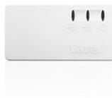
Interface KNX • A utiliser entre le software KNX ETS et les modules KNX • Outil nécessaire pour la programmation des éléments KNX • Version portable (ne nécessitant pas de configuration permanente par installation) • Permet l'enregistrement de télégrammes KNX (jusque 350K events) • Buffer événements transférable au format HTML (pour ETS) ou .CSV
