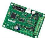
Extension INTEGRA (PLUS) pour le raccordement des modules SA-CA-64 ADR-MOD (hors transfo et boîtier). Raccordement possible d'une alimentation supplémentaire contrôlée SA-APS-412 via connexion rapide.
