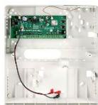
Centrale PERFECTA 32-WRL en petit boîtier en plastique, version française. • Equipée de base de 8 zones, extensible à 32 zones • Equipée d'un transceiver sans fil, 433MHz • Maximum 2+1 partitions • 15 codes utilisateur • Equipée d'origine d'un module de communication GSM/GPRS • Antenne SA-ANT-GSM-I incluse • Boîtier plastique SA-OPU-4P inclus ATTENTION: Nécessite un transfo SA-TR-40VA, non inclus!
