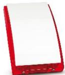
Sirène extérieure avec lampe flash rouge. • Finition blanche en polycarbonate • Flash rouge intégré par LED • 3 tonalités réglables • Volume sonore 120 dBA à 1 mètre • Température de fonctionnement: -35 à 55°C • Dimensions (L x H x P): 148 x 254 x 64 mm ATTENTION : Nécessite une batterie de secours au plomb de 6V/1.3Ah !
