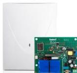
Module répéteur sans fil ABAX2 sur 868 MHz à utiliser pour obtenir une plus grande portée de transmission en combinaison des transceivers sans fils SA-ACU-220 ou SA-ACU-280. Permet d'amplifier les signaux sans fil de 46 dispositifs sans fil ABAX2. Nécessite une connexion 230 Vac et est équipé d'une batterie de secours Lithium-ion. ATTENTION: Nécessite un récepteur SA-ACU-220 ou SA-ACU-280!
