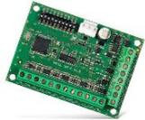
Extension 8 zones pour centrales PERFECTA, VERSA, VERSA PLUS, VERSA PLUS IP, INTEGRA et INTEGRA PLUS (hors boîtier). Raccordement possible d'une alimentation supplémentaire contrôlée SA-APS-412 via connexion rapide.
