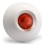
Led de signalisation • Couleur led: Rouge • 4 possibilités de commande: continu, clignotement lent ou rapide, double clignotement avec intervalle • Possibilité de commande par apparition d'une tension de commande (12VDC ou masse commune) • Equipé d'un contact sabotage • Température de fonctionnement: -10 / +55 °C • Tension de fonctionnement: 12 Vdc ±15% • Consommation: 44mA • Raccordement à vis • Boîtier: Blanc & transparent • Dimensions (Ø x H): 97 x 37 mm
