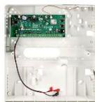
Centrale PERFECTA 16-WRL en petit boîtier en plastique, version française. • Equipée de base de 8 zones, extensible à 16 zones • Equipée d'un transceiver sans fil, 433MHz • Maximum 2+1 partitions • 15 codes utilisateur • Equipée d'origine d'un module de communication GSM/GPRS • Antenne SA-ANT-GSM-I incluse • Boîtier plastique SA-OPU-4P inclus ATTENTION: Nécessite un transfo SA-TR-40VA, non inclus!
