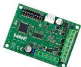
Extension INTEGRA (PLUS) pour le raccordement des modules SA-CA-64 ADR-MOD (hors transfo et boîtier). Raccordement possible d'une alimentation supplémentaire contrôlée SA-APS-412 via connexion rapide.
