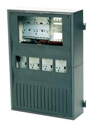
Le boîtier CPH 0006 A peut accueillir une unité de commande et d'affichage MPC avec contrôleur de centrale, jusqu'à six modules, deux batteries 12 V/45 Ah, ainsi qu'un système d'alimentation. Le support d'alimentation est monté en usine.
