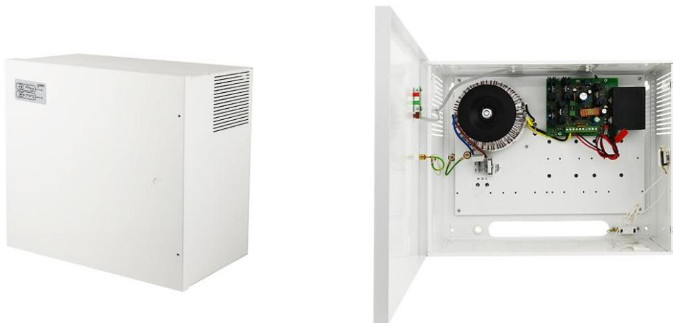
Cette alimentation commutée se caractérise par son haut rendement. Elle délivre une tension stabilisée et ininterrompue de 12VDC (+/- 15%) et peut par exemple être utilisée dans les systèmes de sécurité. Une batterie de secours est immédiatement activée en cas de coupure de la tension secteur. L'alimentation est logée dans un boîtier en métal avec micro-interrupteur pour indiquer l'ouverture de la porte. Ce boîtier peut accueillir une batterie 12V / 18Ah.
