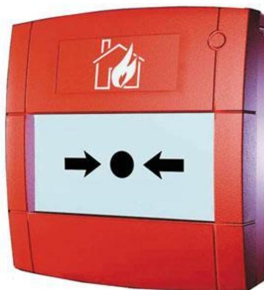
Les déclencheurs manuels intrinsèquement sécurisés répondent à la directive ATEX 94/9/EC et à EN54-11. Les déclencheurs sont installés aisément par le biais de connecteurs coulissants. Ils sont placés dans la zone à risque d'explosion et connectés à une barrière dans la zone sûre qui limite l'énergie à un niveau trop bas pour initier un incendie ou une explosion. Il existe une version intérieure MCP1A-R470FF-01-IS, et une version étanche IP67 pour usage extérieur WCP1A-R470SF-01-IS.
